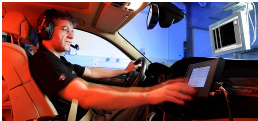
Klimatisierter Allradrollenprüfstand im Institut für Fahrzeugkonzepte
